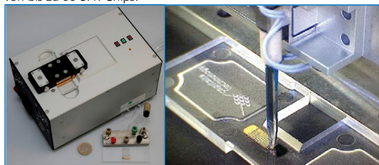
ABB. 1: links: Fraunhofer SPR-Messgerät mit on-chip-Mikrofluidik und SPR-Chip im Vordergrund; rechts: Berührungsfreie Funktionalisierung eines SPR-Chips mit dem Nanoplotter™.
